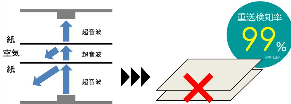
超音波の透過特性を利用し、重送を検知します。また本機能は温度や湿度などの環境条件の変化に感応し、処理過程で自動補正します。
